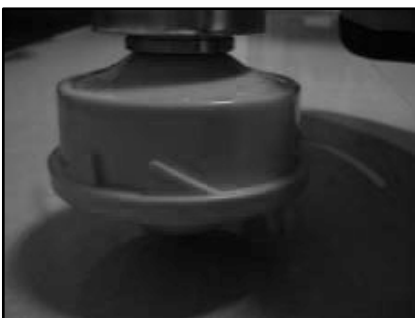
7. Ако користите секач од најлона, пре сечења потребно је да ударите по линији за напајање на тврдом месту.
