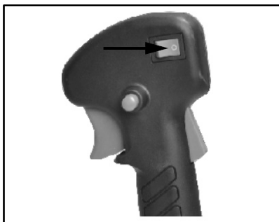
8. Ha bármilyen probléma merül fel, nyomja meg a motor kapcsolóját, és a gép leáll. Ha le kell állítania a vágófejet, engedje el a fojtókar kart.
