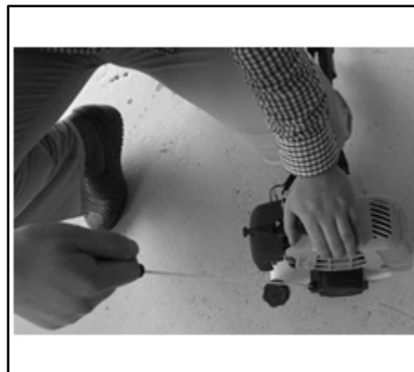
4. Повуците ручку аутоматског стартера да бисте покренули мотор, као што је приказано на слици.
