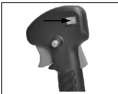
8. Уколико наиђете на било какве проблеме, притисните прекидач мотора и машина ће се зауставити. Ако је потребно зауставити рад резног главића, пустите полуку гаса.
