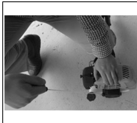
4. Húzza meg a visszahúzó indítókarját a motor beindításához, az alábbi képen látható módon.
